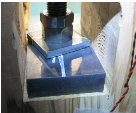
写真 8. 7. 1-116 壁-基礎引きボルトの緩み
