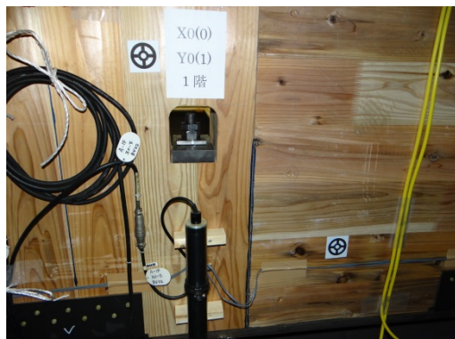
写真 8.7.1-88 壁-垂れ壁間の開き
