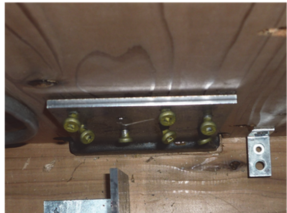
図 8.7.2-48 U形引張金物ねじ抜け
