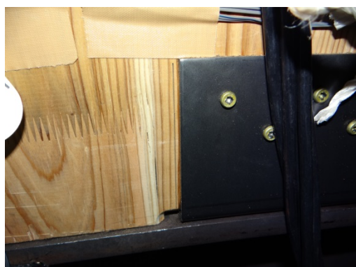
写真 8.7.1-94 U 形せん断金物のずれ
