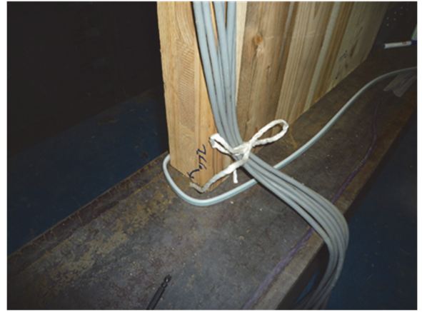
写真 8.7.2-22 壁パネルのつぶれ
