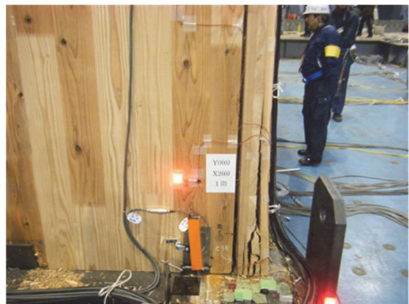
写真 8.7.2-16 壁パネルのラミナ剥離
