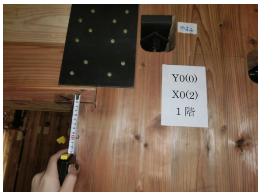
写真 8.7.1-35 垂れ壁と壁間の開き
