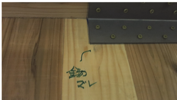
写真 8.7.2-39 L型せん断金物ずれ
