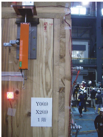
写真 8.7.2-15 壁パネル間の開き
