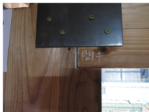
写真 8.7.1-218 壁と垂れ壁間の開き
