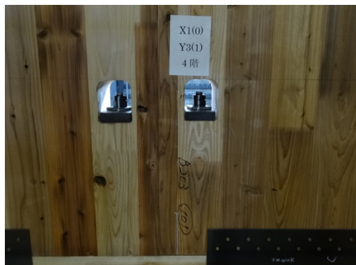
写真 8. 7. 1-290 ラミナ継ぎ目の開き
