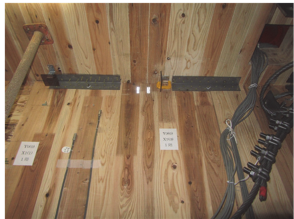
写真 8.7.2-29 L形せん断金物のねじ抜け
