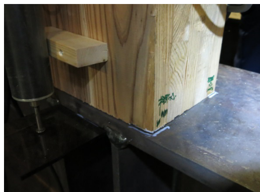
写真 8.7.1-86 壁パネルのずれ 1mm
