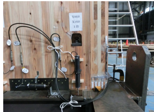
写真 8.7.1-11 ラミナ表層の割れ
