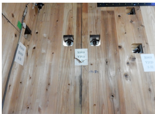
写真 8.7.1-326 壁パネル間の開き
