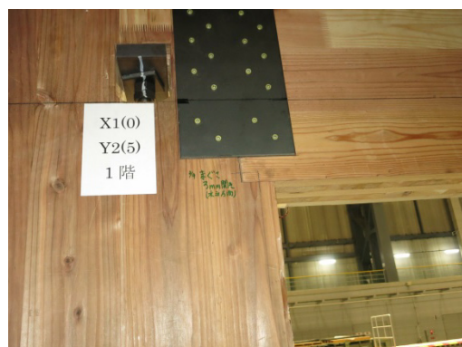
写真 8. 7. 1-68 垂れ壁と壁間の開き
