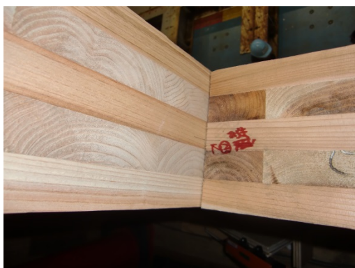
写真 8. 7. 1-158 腰壁パネルの開き
