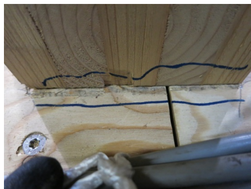
写真 8.7.1-283 壁パネルと床の開き
