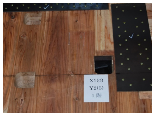
写真 8. 7. 1-51 目地の開きと表層ラミナの割れ
