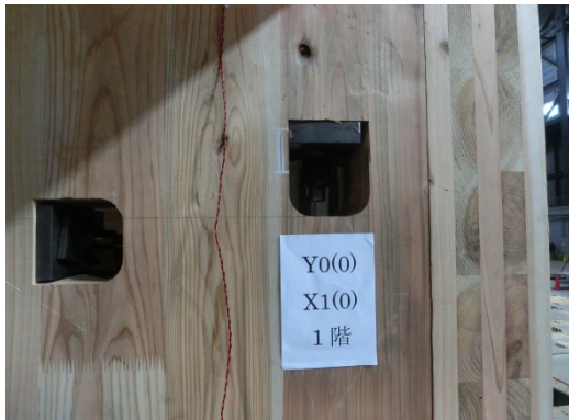
写真 8.7.1-10 ラミナ表層の割れ
