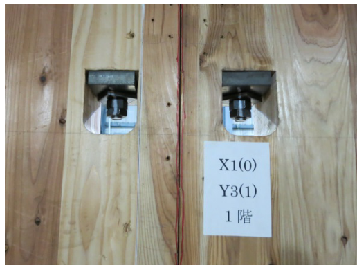
写真 8.7.1-58 壁パネル間の開き
