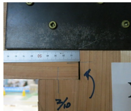
写真 8.7.1-107 垂れ壁-壁のずれ
