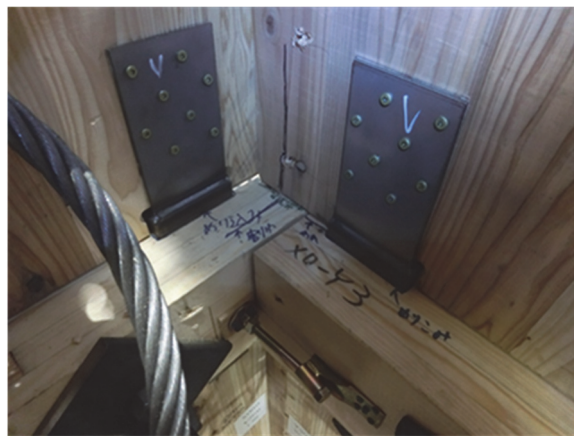
図 8.7.2-44 U形引張金物めり込み
