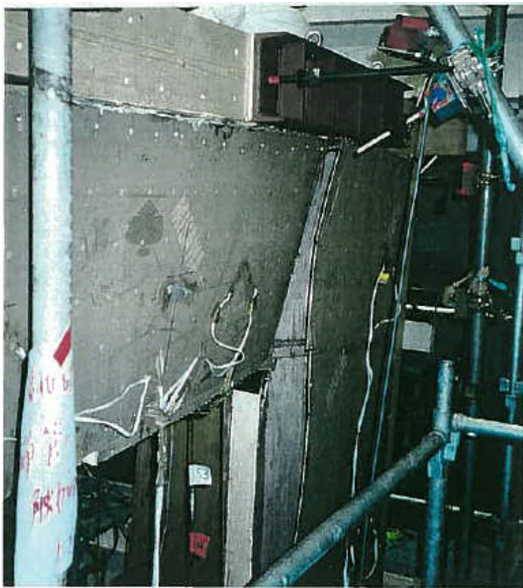
写真 13 壁パネルの面外座屈。(WoX 8 2, WoX 0 3)
