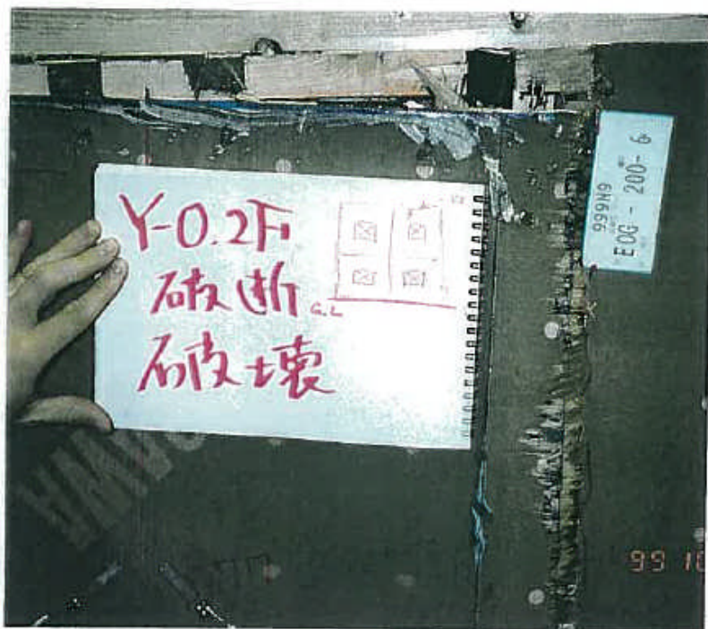
写真 10 小壁パネルのせん断破壊。(WoY 0 5, WoY 0 6)
