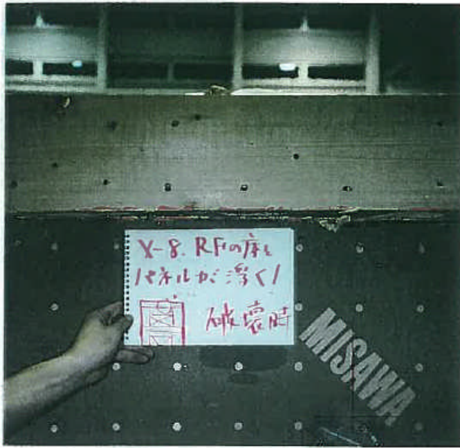
写真3 壁から床が離れた。(GX 8 2, WoX 8 2, WoX 8 3)
