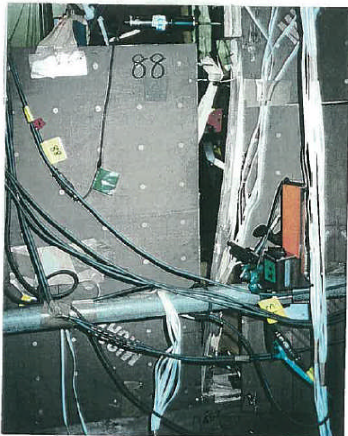
写真 9 小壁と耐力壁の接合部が剥離した。(WoY 0 15, WoY 0 16)
