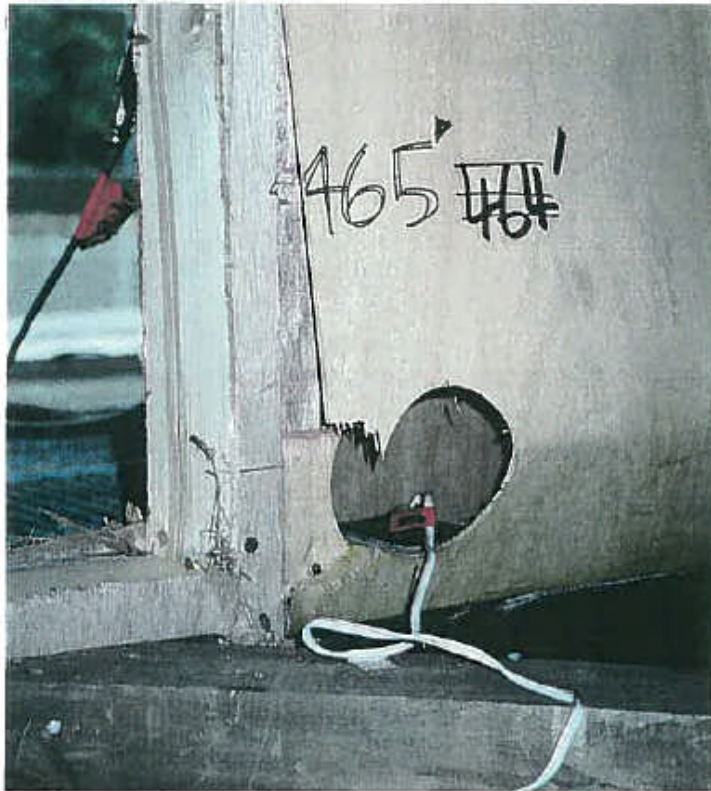
写真7 合板がせん断破壊した。(WiX 8 4)
