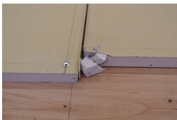
4.8×50mm 一方向 ボードの欠け
