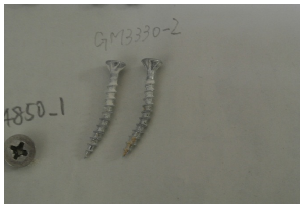
3.3×30mm 一方向 ビス曲げ変形
