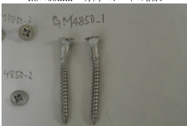
4.8×50mm 一方向 ビス曲げ変形
