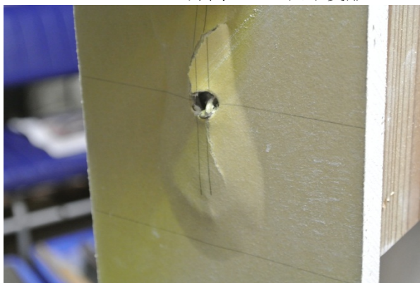
4.8×50mm 繰り返し ボードの破壊
