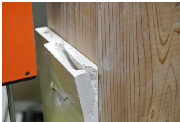
4.8×50mm 一方向 ボードの割れ
