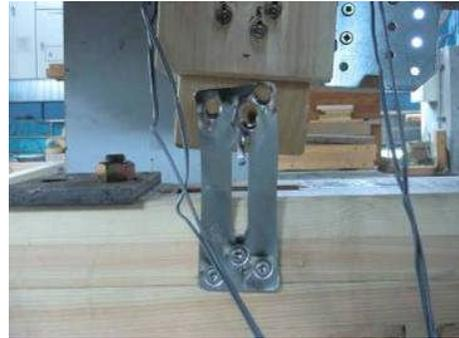
写真 3.5.1-1 接合部金物の破壊
